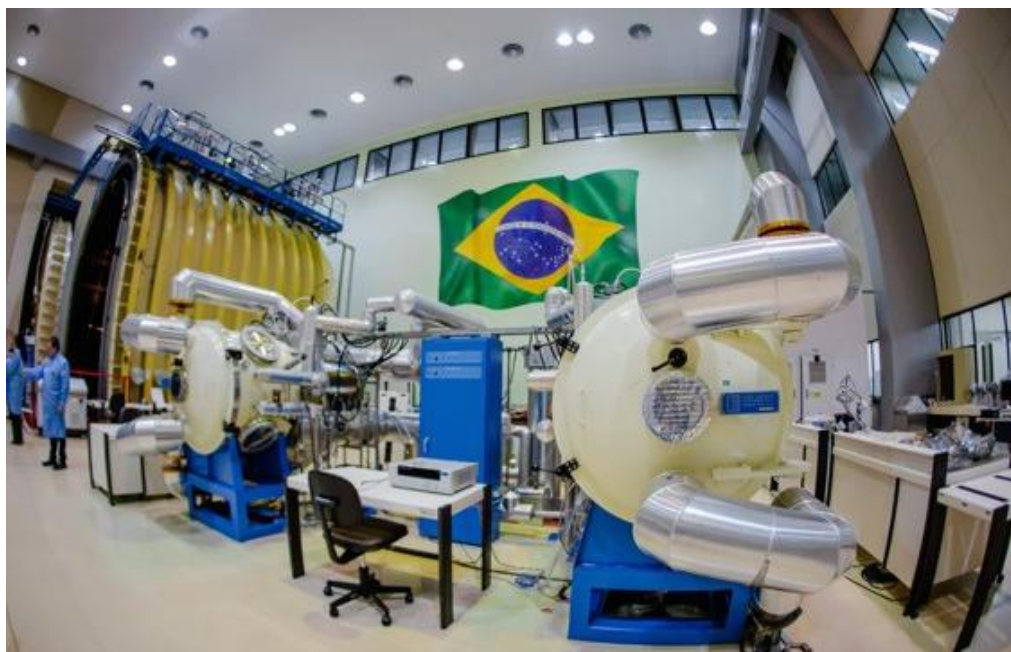
Figura 26 - Sistemas para testes vácuo-térmicos no LIT.
