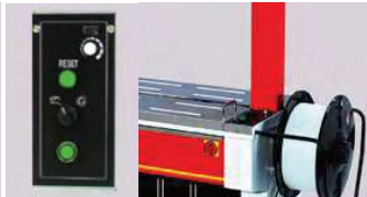
Electronic tension control via dial knob. Kiểm soát lực căng điện tử bằng nút xoay.
