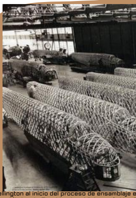
Fuselajes del Wellington al inicio del proceso de ensamblaje en la fábrica de Brooklands. - Vickers via Ken Ellis.
