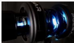
Motor de Sunbird a base de plasma con kriptón Fuente: Pulsar Fusion
