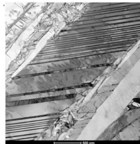
TEM of as-fabricated L-PBF-Ti64
