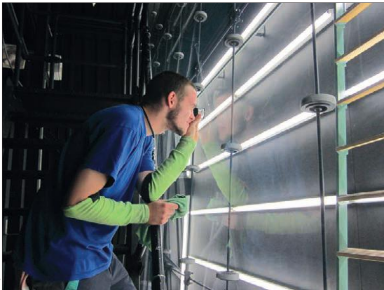
Qualitätskontrolle mit der Lupe: Schon kleinste Einschlüsse von Luftbläschen würden die Flachglasscheibe zu Ausschuss machen
